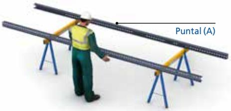
Fije los pies (F) a los puntales (A) mediante dos tornillos M10x30 (H) y dos arandelas (I), teniendo en cuenta que la parte estrecha de las perforaciones (J) debe ir hacia abajo.
